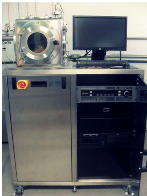
Figura 29 - Reator automatizado NPE4000 NANO-MASTER.[24]
