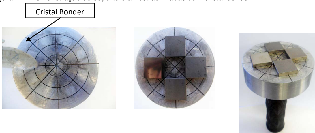
Figura 24 - Demonstração do suporte e amostras fixadas com cristal bonder
